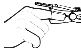
Fig.3-2colocación del sensor
